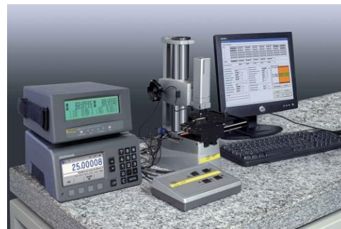
Prüfung eines Endmaßes mit einem taktilen Messverfahren 93
