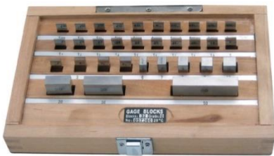
Endmaßsatz aus Stahl 91
