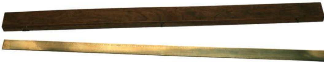
Der erste provisorische Urmeter von 1795 aus Messing (0,013 % zu lang)
