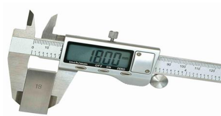
Prüfung einer digitalen Schieblehre mit einem 18-mm-Endmaß
