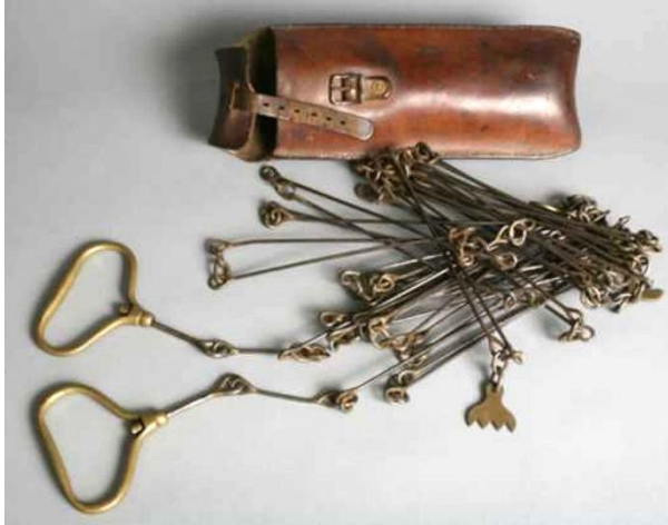
Markscheider-Messkette aus Messing
