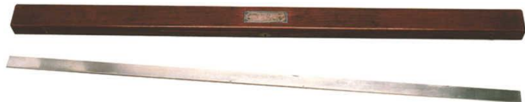
Der zweite Urmeter von 1799 aus Platin (0,02 % zu kurz)
