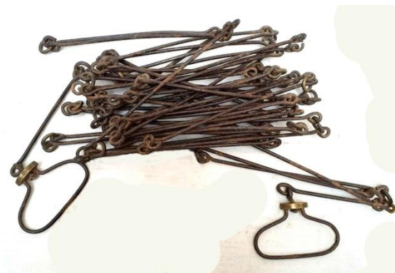
Messkette aus Stahldraht um 1900
