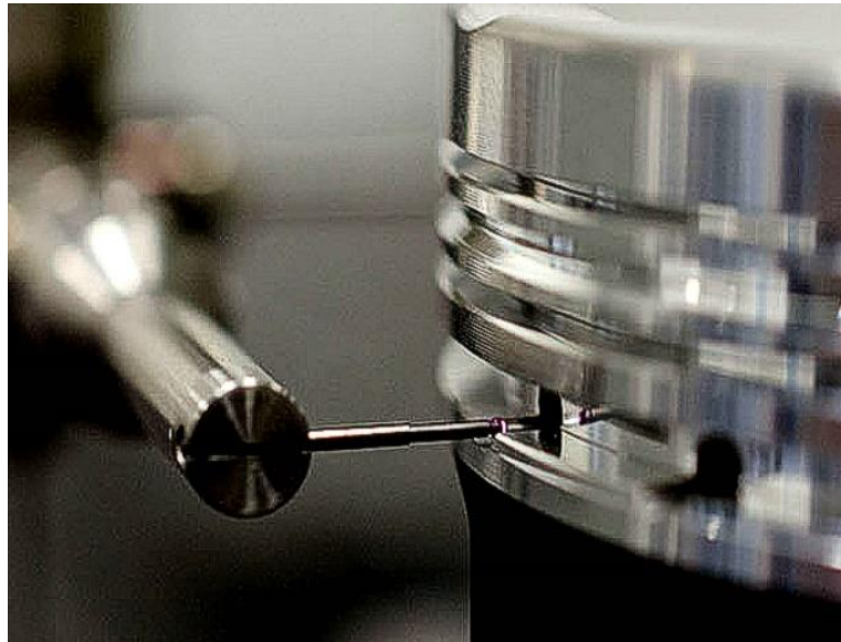
Taktile Vermessung eines Werkstücks 90
