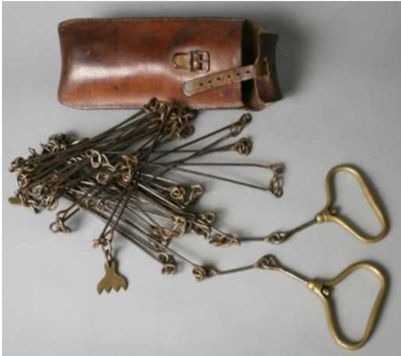
Auch Markscheider verwendeten bis Ende des 19. Jahrhunderts spezielle Messketten, die sogenannten Lachterketten. Verwendet wurden sie über Tage bei einer Mutung, bei der Abgrenzung einer Schürfstelle und unter Tage bei Vermessungsarbeiten in den Stollen. Bei Vermessungen unter Tage durften wegen einer möglichen Funkenbildung keine Messketten aus Stahl sondern nur solche aus Messing verwendet werden. Das war Vorschrift.
