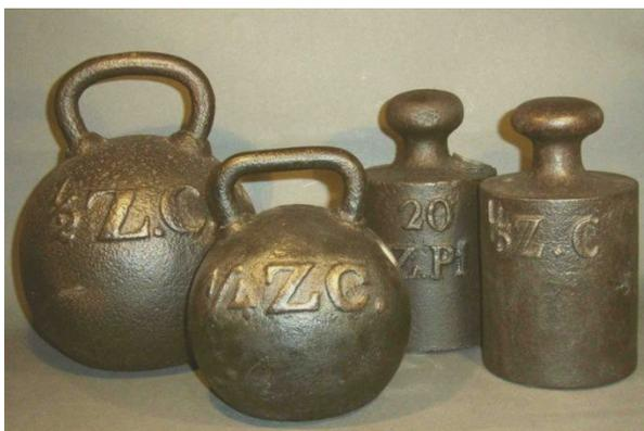
Die normalen Gewichtsformen waren in Preußen die Kugel mit Griff bei den Größen 1,  $\frac{1}{2}$  und  $\frac{1}{4}$  Zollzentner sowie die Gewichte in zylindrischer bis leicht konischer Form mit Knopf.
