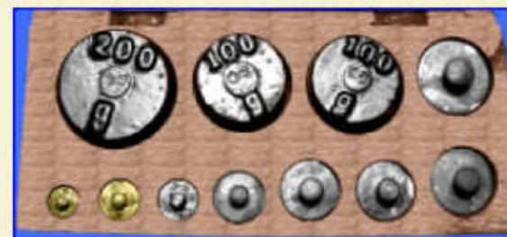
*Abbildung 153* zeigt einen kompletten deutschen Gewichtssatz in einer ungewöhnlichen Bestückung. Alle Gewichte wurden im zweiten Weltkrieg (1942 / 1943) geeicht. Die Gewichte zu 200 und 100 g sind Scheibengewichte aus Gußeisen, die von 50 bis 5 g sind aus Zink und die zu 2 und 1 g sind aus Messing gefertigt.
