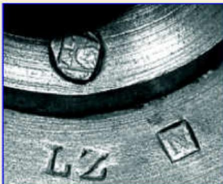
Abbildung 68 zeigt die Schulter eines relativ wenig abgenutzten Zinkgewichtes zu 500 g - ebenfalls von Léon Zwiebel (LZ). Es trägt den französischen Stempel der Ersteichung, die "Händchen" mit den Buchstaben „A.L.“ für Alsace-Lorraine (Elsaß-Lothringen) sowie den Jahresstempel „N“ für 1945. Die Eichung erfolgte mit ziemlicher Sicherheit unmittelbar nach Abzug der deutschen Truppen aus Elsaß-Lothringen.
