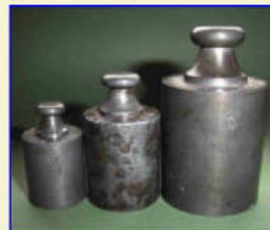
Abbildung 76 zeigt einige niederländische Gewichte aus Zink aus der Zeit des zweiten Weltkrieges zu 100, 200 und 500 g. Als Bezeichnungen waren zugelassen **kilogram** und **gram** auf der Oberseite des Rumpfes, wobei für Gewichte unter 100 g auch die Abkürzung **g** erlaubt war.
