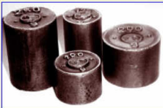
Abbildung 11 zeigt Gewichte aus Sintereisen aus der Zeit nach dem zweiten Weltkrieg. Die beiden erhabenen Punkte sollen den Zweck haben, Gewichte aus Sintereisen von denen aus Gußeisen unterscheiden zu können. Durch das Rundschriften der PTB Braunschweig vom 2. Mai 1957 wurden die Ausnahmegenehmigungen für Gewichte aus Ersatzstoffen - wie Zink, Porzellan, Glas und Sintereisen - zurückgenommen. Wörtlich heißt es in der Verordnung:
