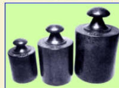
*Abbildung 61* zeigt drei zugelassene Zinkgewichte aus dem zweiten Weltkrieg zu 200 g, 500 g und zu 1 kg in der klassischen Form der Messinggewichte. Sie sind kaum von denen aus dem ersten Weltkrieg zu unterscheiden, weil sie in den meisten Fällen nicht, wie vorgeschrieben, mit „X“ gekennzeichnet sind.
